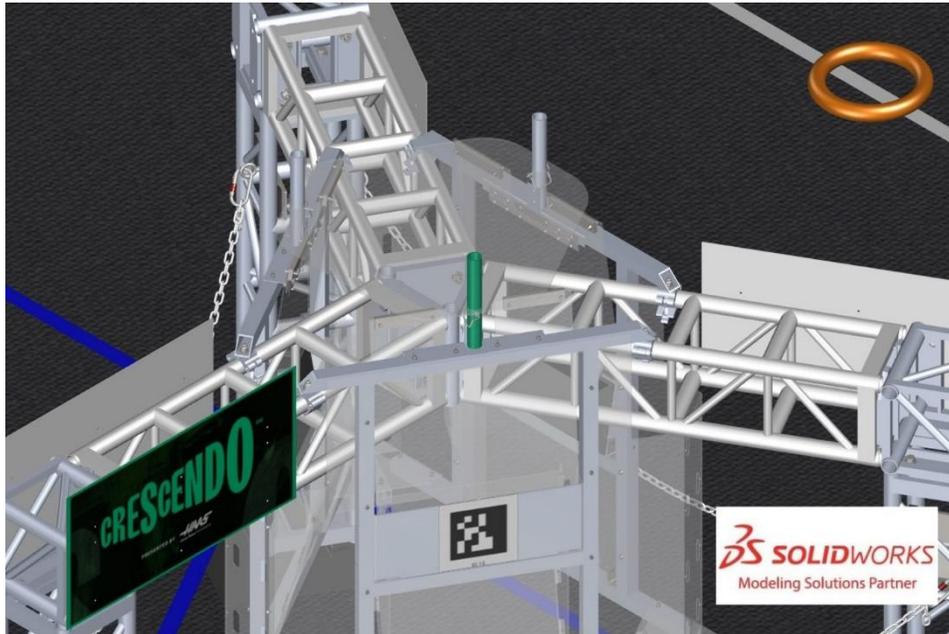
指挥台(PODIUM)是一块涂有所属联盟的颜色的高密度聚乙烯板(HDPE)，安装在面向联盟墙的舞台支柱上。每个指挥台高 1 英尺 5¾英寸，宽 10 英寸（约 45 厘米 x 约 25 厘米），安装在桁架脚顶部的正上方。
