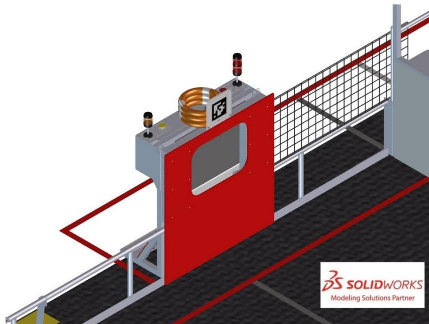
扩音器（简称 AMP）是机器人用于向联盟区域传递音符的结构。每个联盟有 1 个扩音器。每个扩音器都有一个深 3¾英寸（约 10 厘米）、高 1 英尺 6 英寸（约 46 厘米）、宽 2 英尺（约 61 厘米）的垂直口袋。口袋底部距离地毯 2 英尺 2 英寸（约 66 厘米）。每个扩音器距最近的联盟墙 4 英尺 1½英寸（约 126 厘米）。
