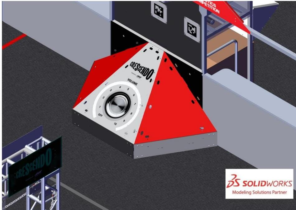
低音炮是一个 6 面元件，位于每个扬声器下方的中心位置，并靠着联盟墙。低音炮高 3 英尺 1 英寸（约 94 厘米），垂直面板高 8 $\frac{3}{8}$ 英寸（约 21 厘米）。低音炮伸出联盟墙 3 英尺 $\frac{1}{8}$ 英寸（约 92 厘米）。垂直面为黑色高密度聚乙烯(HDPE)，侧面倾斜面为涂有所属联盟的颜色的高密度聚乙烯，中间倾斜面板为乙烯基涂层聚碳酸酯 (vinyl-coated polycarbonate)。
