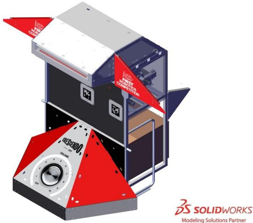
扬声器由一个低音炮和所有位于联盟墙上方和后方的元件组成。扬声器有一个开口，机器人可通过该开口用音符得分。这个开口由扬声器的零件和联盟墙顶部围成。扬声器开口的最低边缘距离地毯 6 英尺 6 英寸（约 198 厘米），开口的最高边缘距离地毯 6 英尺 10<sup>7</sup>/<sub>8</sub>英寸（约 21 厘米）。开口宽 3 英尺 5<sup>3</sup>/<sub>8</sub>英寸（约 105 厘米），并向场地内延伸 1 英尺 16 英寸（约 46 厘米）。开口平面与地毯成 14 度的向上夹角。扬声器内的顶部形成一个凹面，音符会在凹面下反弹。
