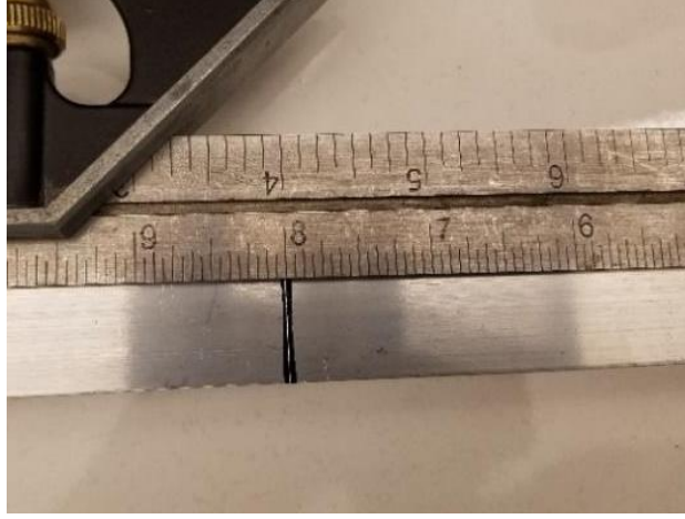
Şekil 5: Dikey Boru Üzerinde 8 inç İşaretleme
