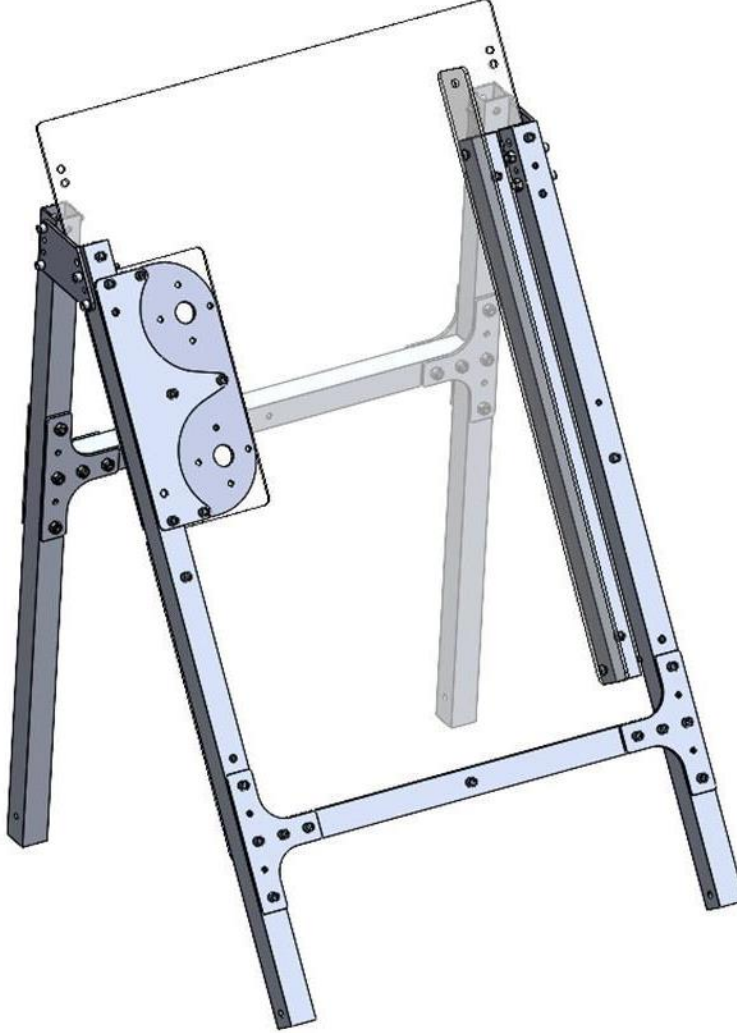
Şekil 32: Fırlatma Rayının Takılması
