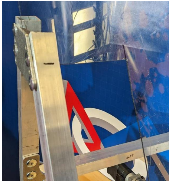
Şekil 28: Çapraz Borunun İşaretlenmesi
