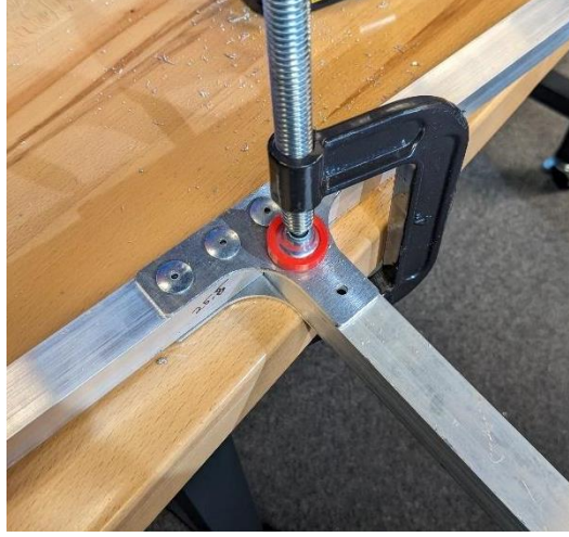
Şekil 9: Yatay Borunun Sabitlenmesi
