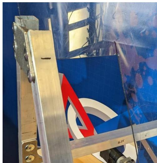
**Paso 2:** Alinee el conjunto de soporte del soporte del motor de modo que las placas de montaje del tubo estén en lados opuestos del tubo diagonal marcado y alineados con la línea marcada. El espaciador de ¼ de pulgada debe estar en la parte inferior y el espaciador de 5/8 de pulgada debe estar en la parte superior cuando esté ensamblado.
