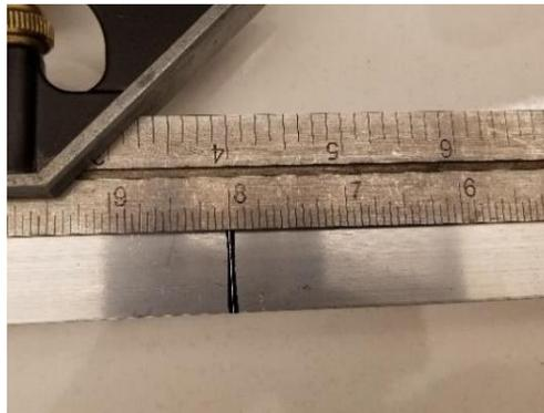
**Paso 2:** Usando las marcas en un tubo vertical, coloque 2 soportes en T, uno a cada lado del tubo, de modo que la parte superior de cada soporte esté alineada con el lado más alejado de la marca (de modo que las 8 pulgadas medidas queden completamente expuestas) y el borde largo de cada soporte en T quede al ras con el borde exterior como se muestra en la Figura 6.
