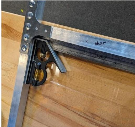
**Step 7:** Para perforar el segundo orificio a lo largo del tubo horizontal, es posible que deba quitar y reubicar la abrazadera, o utilizar solo los accesorios iniciales y una escuadra para ayudar a mantener las cosas alineadas. Agregue el hardware de su elección para completar la conexión.
