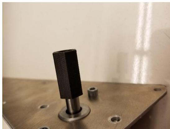
**Paso 3:** Deslice una rueda sobre cada adaptador hexagonal con la cara plana de la rueda hacia arriba. Deslice un clip de retención, con los dientes inclinados hacia usted, sobre cada eje y presione hacia abajo hasta que llegue a la rueda como se muestra en la Figura 40.
