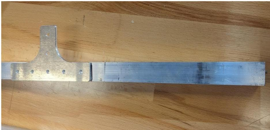
**Paso 3:** Sujete los soportes en T en su lugar y, utilizando un soporte como plantilla, taladre un agujero a lo largo de la barra. Agregue los accesorios de su elección al orificio para conectar el soporte en T a la barra.
