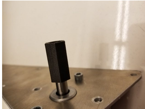
Figure 39: Installation de l’adaptateur hexa
