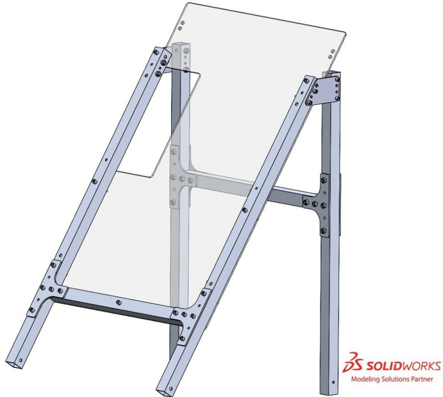
Figure 21: Assemblage des cadres ensemble
