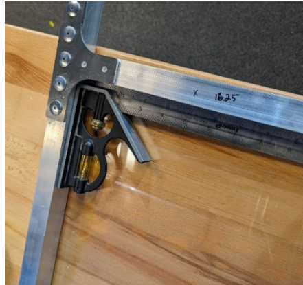
Figure 15: Fixation du tube horizontal au cadre arrière
