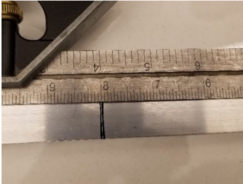
Figure 5: Marquage à 8 po. sur tube vertical
