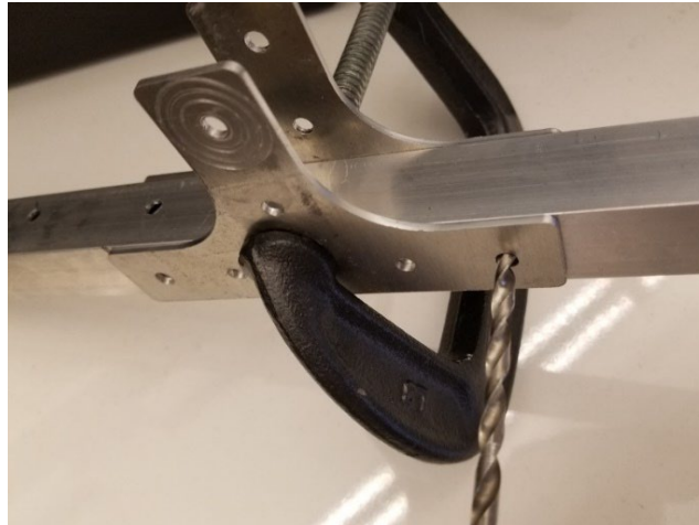
Figure 7: Serrage des supports en T au tube
