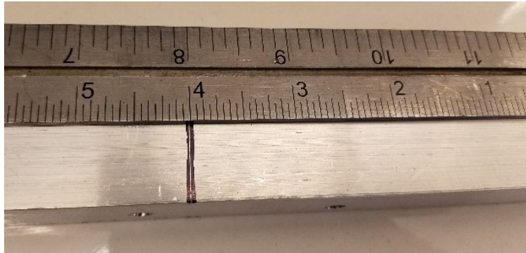
Figure 12: Marquage à 4 po. sur le tube
