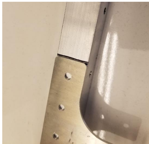
图 6：正确放置 T 形托架
