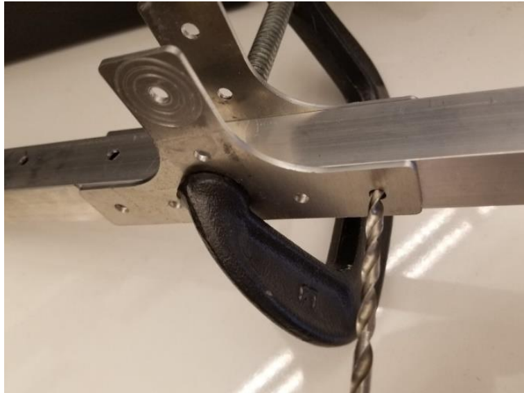
图 7：将 T 形托架夹紧到横梁上
