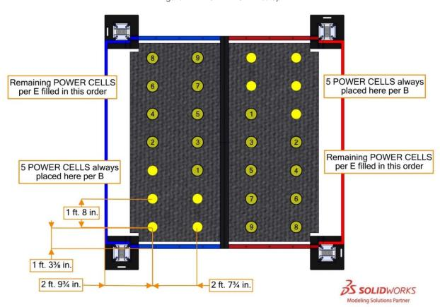
Figure 4-2: POWER CELL setup inside RENDEZVOUS POINT
