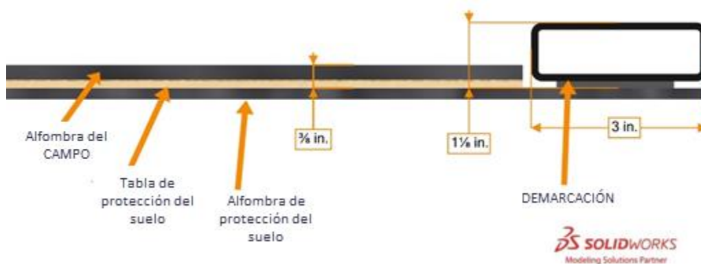
Figura 3-11 corte transversal de la protección del suelo
